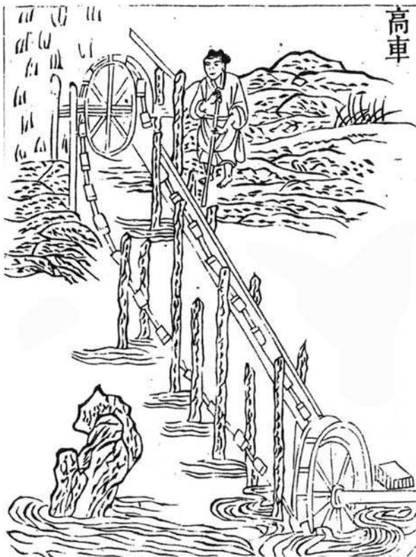
Pompa berantai bangsa China yang digunakan untuk keperluan irigasi.
